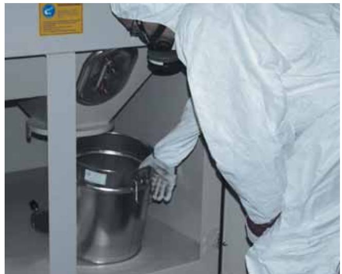
Bild 11: Entfernen des Staubsammelbehälters mit anschließender Entleerung.
