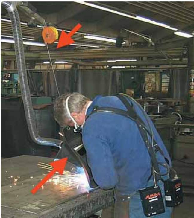
Bild 1: Erfassungseinrichtung prüfen, keine Knicke in der Schlauchverbindung (Rohrleitung), Zugentlastung leicht einstellen.
