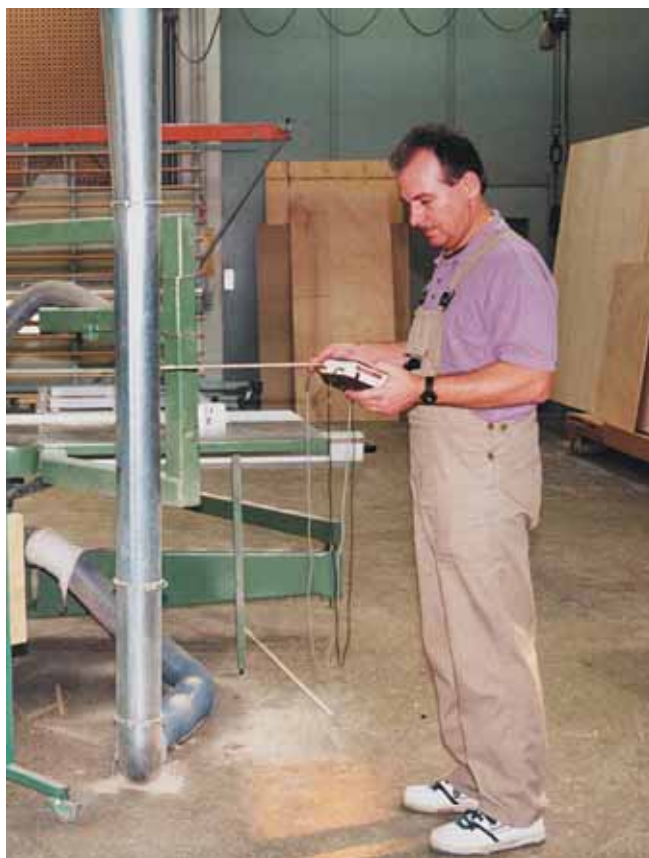
Bild 7: Messung der Strömungsgeschwindigkeit mit einem Flügelradanemometer in einer Rohrleitung.
