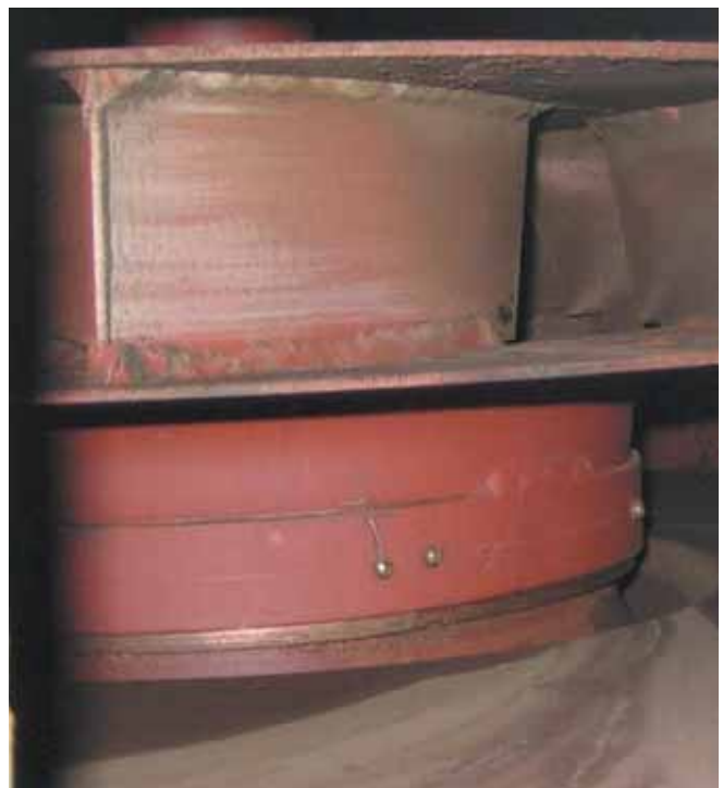
Bild 4: Laufrad auf Verschmutzung und Laufruhe prüfen.
